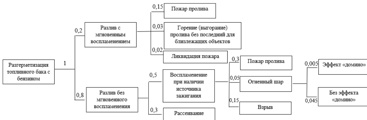
Рисунок 1 – «Дерево событий» при разгерметизации топливного бака
